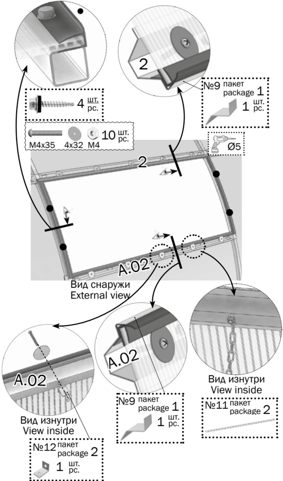
Соберите каркас форточки из деталей №1, №2, №3. Установите нижнюю петлю (2 шт.) и кронштейн на каркас. Установите крепеж, чтобы закрепить цепь.
